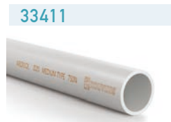
EN 61386-21 Αντοχή στη συμπίεση: 750Nt/5cm Αντοχή στην κρούση: 2J
