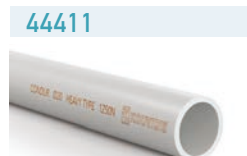
EN 61386-21 Αντοχή στη συμπίεση: 1250Nt/5cm Αντοχή στην κρούση: 6J
