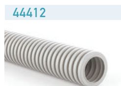
EN 61386-22 Αντοχή στη συμπίεση: 1250Nt/5cm Αντοχή στην κρούση: 6J
