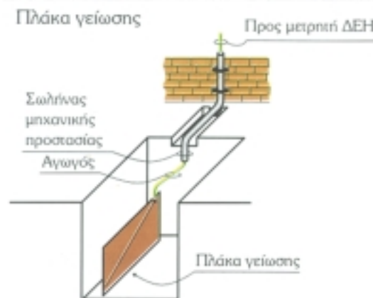
Σχήμα 3.3.5 Γείωση με μεταλλική πλάκα
